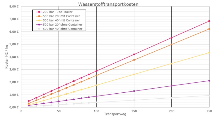
Abbildung 36: Darstellung der Transportkosten für Wasserstoff in Abhängigkeit des Transportdrucks 75
